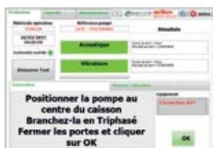
Face-avant de l'interface homme-machine du poste vibro-acoustique.
