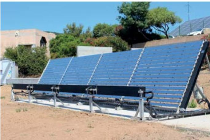
Système Réfléchissant à Lames Orientables (SRLO).
