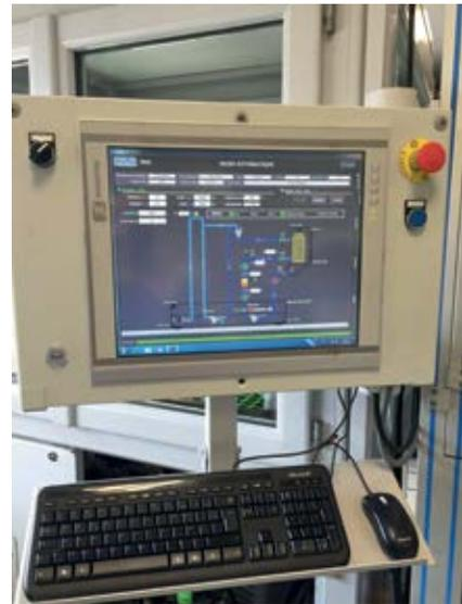
*Un panel PC dialogue en Ethernet avec le châssis CompactRIO chargé de l'ensemble du contrôle/commande du banc, de la génération des cycles de pression, et de l'acquisition des mesures de pression et températures pour les essais d'endurance de pression pulsée d'huile sur échangeurs.*
