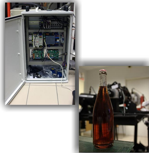
Fig.1: L'IHM permet le contrôle-commande d'un châssis cDAQ, d'un automate, de deux caméras hautes vitesses et de deux pots vibrants.
