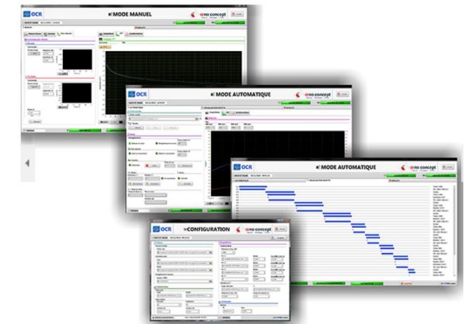
Fig.2: Un PC dialogue en Ethernet avec le châssis cDAQ chargé de l'ensemble du contrôle-commande du banc, de générer les cycles de remuage, de faire l'acquisition des mesures et des générations de signaux.
